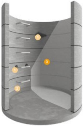
Los depósitos de agua suelen ser estructuras que están sometidas a una elevada y permanente presión ejercida por el agua que confinan. Por tanto, se requiere de un sistema completo que garantice la estanqueidad absoluta de los puntos más críticos: estructura, juntas. La impermeabilización de estructuras de agua potable requiere de materiales no solo que impermeabilicen sino que sean certificados para este uso
